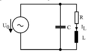
Werte:  $I_L = 4A$ ,  $R = 5\Omega$ , L = 32mH,  $C = 320\mu F$ , f = 50Hz
