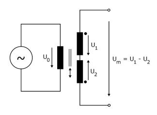
U<sub>0</sub> an Primärspule Sekundärspulen mit je umgekehrten Wicklungssinn
