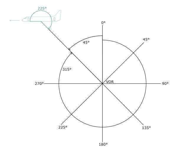
Aus der Zeichnung wird das Ergebnis mit einem Winkel von 225° ersichtlich
